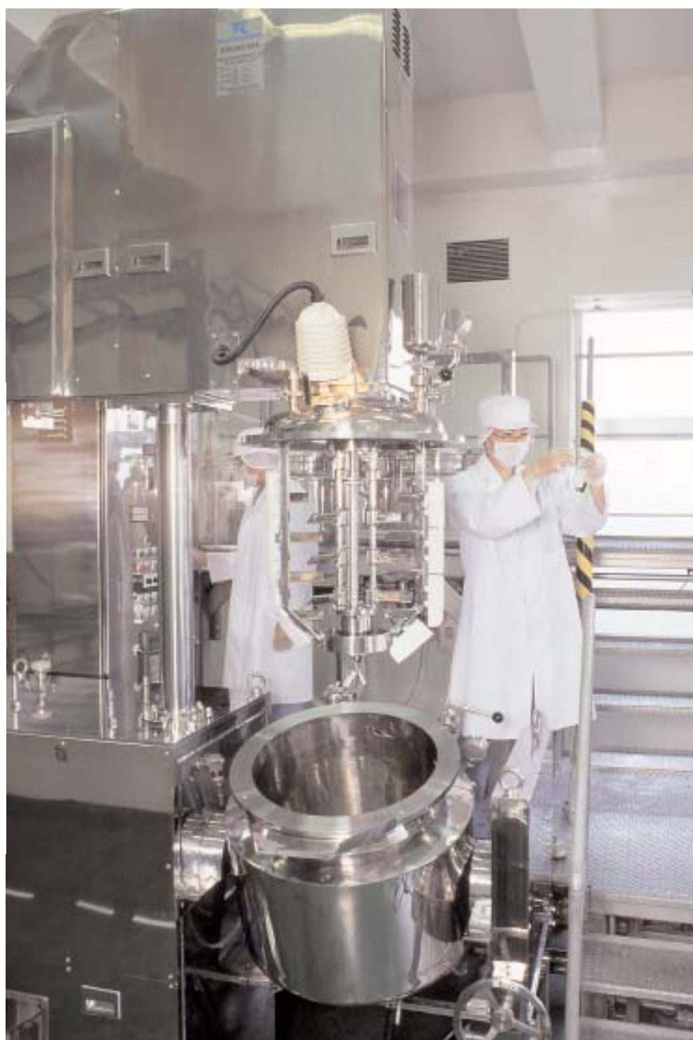
化粧品調合設備(パイロットプラント)
